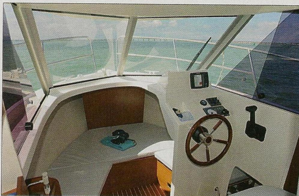
sa nouvelle version, le rouf adopte des formes plus anguleuses avec une surface plane sur le dessus. Concernant le balcon en inox, ce dernier a été rehaussé et il est à présent doté de deux lignes de tubes qui le rigidifient et offrent une prise en main supplémentaire.
