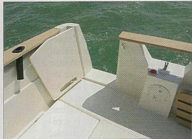
Dans le cockpit, il est possible de transformer l'un des coffre latéral en vivier en fonction des besoins. A l'arrière, le portillon est situé sur tribord. Au centre, il est facile d'installer la barre franche sur son support afin de piloter le bateau depuis le cockpit. Des doubles commandes sont proposées en option.
