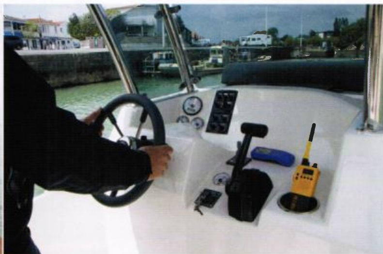
Bien agencée, la planche de bord laisse la part belle à électronique sur la partie droite. Le volant et la poignée de gaz trouvent naturellement leur place sous la main.
