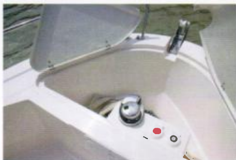
Surdimensionnée la baille à mouillage dispose d'un guideau électrique proposé en option.
