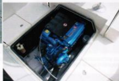
Le Nanni T4-200 est un moteur diesel, fiable et plutôt discret. Un bon choix pour propulser cet open.
