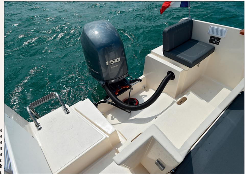
▲ La partie centrale de la banquette de cockpit bascule vers l'avant pour permettre de relever le moteur. Un petit vérin faciliterait sa manipulation.
