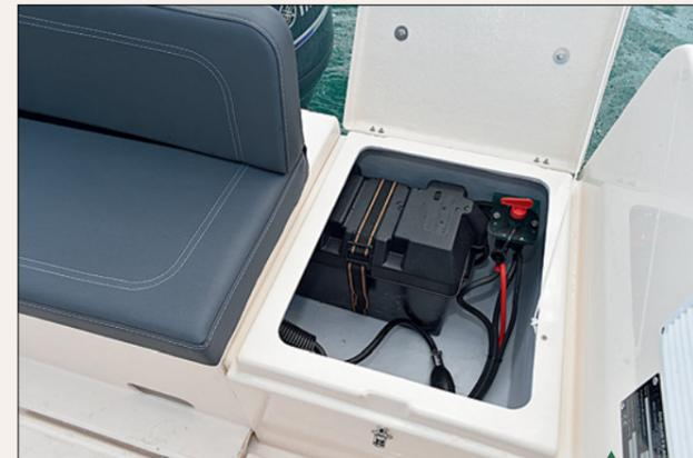
▲ L'accès à la batterie et au coupe-circuit est facile; les deux se trouvent sous l'assise à l'extrémité bâbord de la banquette du cockpit.
