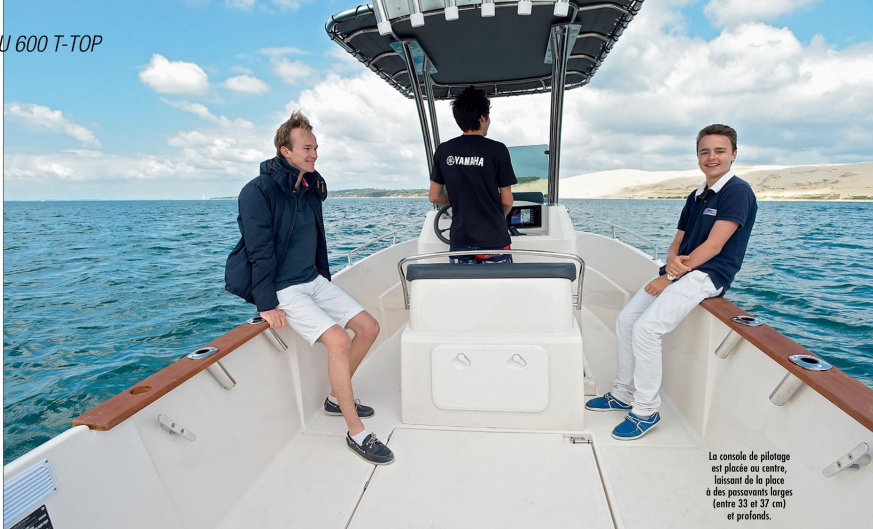
La console de pilotage est placée au centre, laissant de la place à des passavants larges (entre 33 et 37 cm) et profonds.
